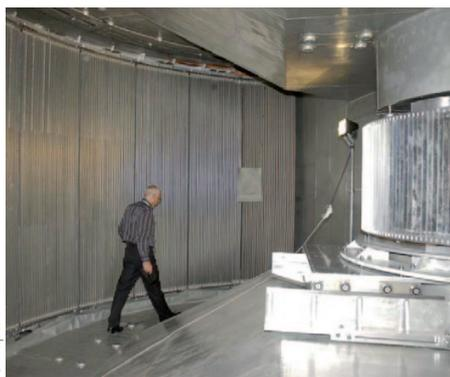
2. Détecteurs de neutrons de l'instrument IN5 à l'Institut Laue-Langevin (Grenoble) : les tubes sont remplis d'hélium-3 sous pression.
